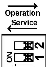
Внутри модуля находится многопозиционный переключатель (Рис. 3) для переключения показаний дисплея (выключатель 1) и для переключения на внешний датчик давления (не тот, что на фланцах насоса) для входного напряжения 0...10V (выключатель 2):
