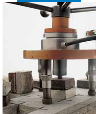
Испытание на адгезию SATTEC
