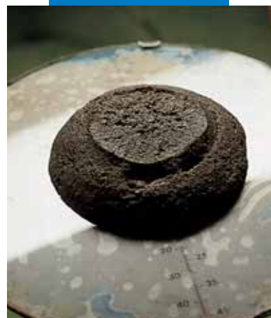
Определение расплыва конуса (согласно UNI 7044/72)
